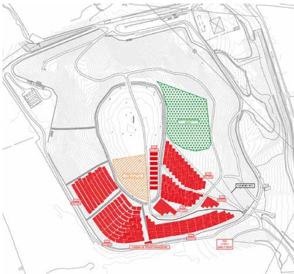
L'area della ex discarica: in rosso la superficie interessata dal nuovo impianto fotovoltaico da 3MW.
